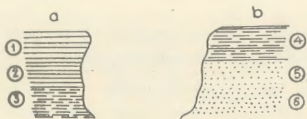
Fig. 2: SEKUENCA TIPIKE NË DEPOZITIMET TURBIDIKE (SI-PAS A. BQUMA-s - 1962) DHE INTERPRETIMI I TYRE.
