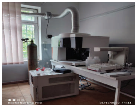
Figura 12. ICP-OES, Plasma Quant 9100. Përcaktimin e metaleve të rëndë në ujëra. Përcaktimin e elementeve në minerale të ndryshme, mostra mjedisore, xeherorë në nivele mikroelementë. Metalet e çmuara. Metalet alkalino-tokësore. Metalet e tokave të rralla.
