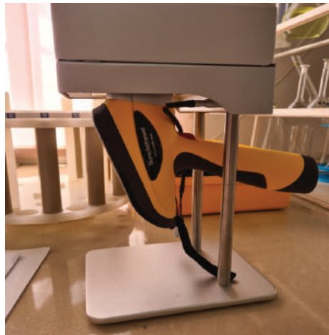
Figura 13. X-Fluorescence, Skyray Instrument, Explorer 7000. Detektimin e elementëve kimike në shkëmbinj të ndryshëm
