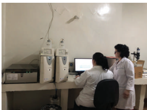
Figura 9. Ion Chromatograph, Dionex ICS-1100. Përcaktimin e anioneve dhe kationeve në mostrat ujore (Anione - F^- , Cl^- , NO_3^- , NO_2^- , SO_4^{2-} , PO_4^{3-} dhe katione - NH_4^+ , K^+ , Na^+ , Ca^{2+} , Mg^{2+} ).
