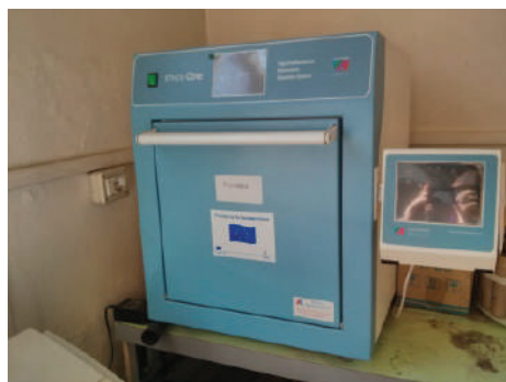
Figura 14. Mikrovalë, Ethos Easy. Disgregimin e mostrave të ngurta në minerale
