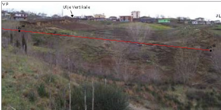
Figura 4. Pozicioni i kryerjes së profilit sismik (I-I) sipas valëve të refraktuara dhe sipërfaqësore (Figura1)
